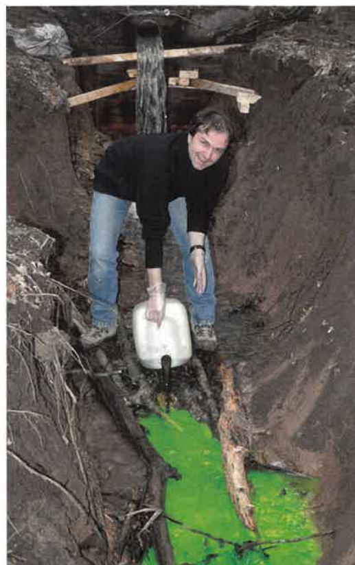
Figure 5 – Injection de l'uranine à la Triple Douve le 19 mars 2005 à 16h46. Photo R. Bay.
